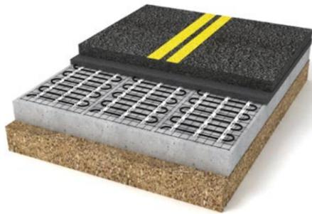
Auf die Betonsohle des Untergrundes werden in einer ersten Schicht Gussasphalt die Heizmatten Typ AFH gemäß Plan verlegt und eingebettet. Die Kaltleiter werden seitlich an den Heizmatten vorbei zu den Anschlusspunkten geführt.
