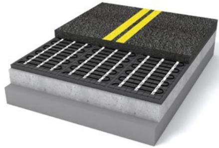
Auf die Betonsohle des Untergrundes wird die erste Schicht Asphalt, mit einer Stärke von etwa 25 mm, gegossen. Im Anschluss werden nach dem Abkühlen der ersten Asphaltsschicht die Heizmatten gemäß Plan verlegt. Das Glasfasergewebe verhindert ein Aufschwimmen der Heizmatten. Die Kaltleiter werden seitlich an den Heizmatten Typ ABR vorbei zu den Anschlusspunkten geführt. Abschließend folgt die zweite Asphaltsschicht, die eine Stärke von etwa 30-70 mm erreichen sollte.
